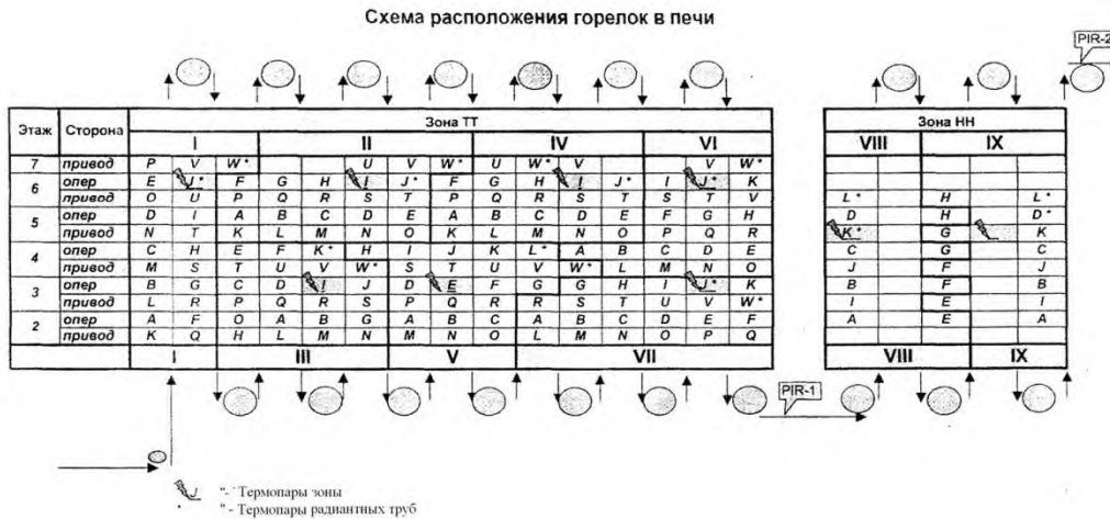
Рисунок 1.3 – Схема расположения горелок в печи в отделениях нагрева и выдержки и разбиение рабочего пространства на зоны управления
