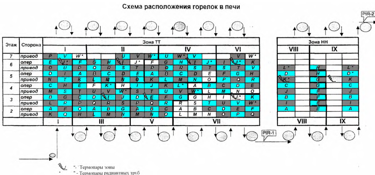
Рисунок 4.1 – Расположение включенных горелок на первом шаге для таблиц 1 и 2
